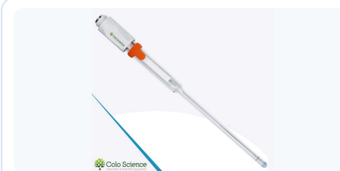
PRO6146 pH-Elektrode, schlank Dünner Schaft \Phi 6 \times 100 mm für kleine Gefäße und Reagenzgläser; S7-Kopf, Anschluss per Kabel. Optional
