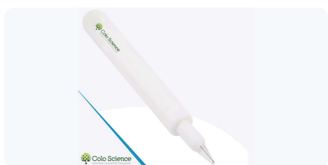
PRO6137 pH-Elektrode E-201-Z, Einstichspitze Spitze für halb feste Proben; Ag/AgCl, \Phi 12 \times 120 mm, BNC (Q9) — direkt anschließbar. Optional
