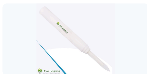
PRO6144 pH-Elektrode, Messerform (Blade Spear) Messerförmiger Schaft aus POM / Edelstahl 316 für Käse, Fleisch und Obst; S7-Kopf, Anschluss per Kabel. Optional
