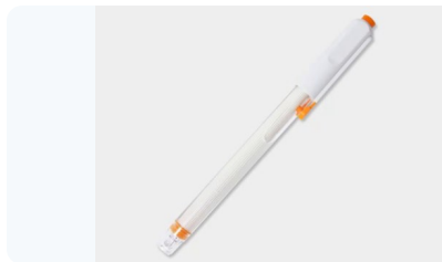
PRO6139 pH-Kombielektrode E-201-L Ag/AgCl-Referenz, \Phi 12 \times 120 mm, BNC-(Q9)-Stecker. Standardlieferung
