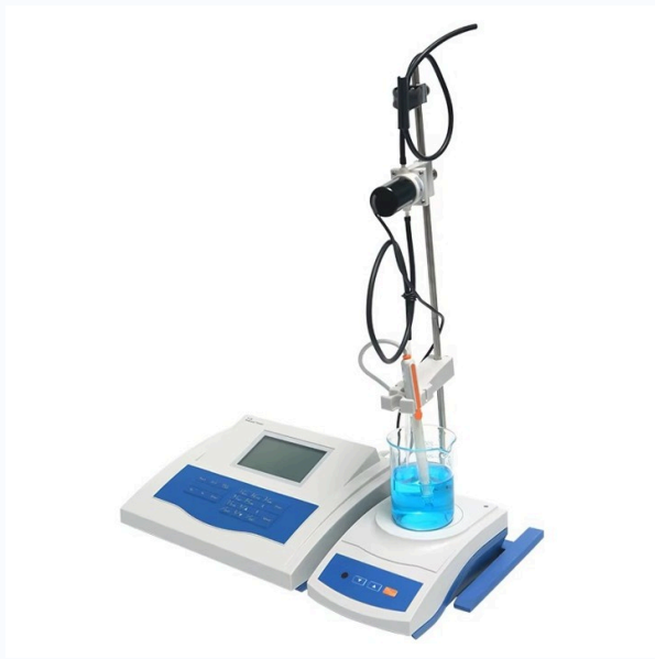
TITRO20 sa magnetnom mešalicom JB-10, stalkom i elektrodama
