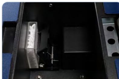
Komora za transmisiju sa komponentom za merenje i crnom pregradom
