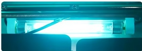
Lampă UV de dezinfecție în camera de lucru (STOLAB100, STOLAB200)
