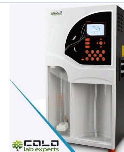
Celoten Kjeldahlov sistem • digestor, pralnik in destilacijska enota iz enega vira
