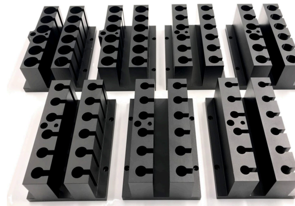
Sedam izmenjivih blokova sa prorezima, epruvete Ø 10 mm do Ø 20 mm
