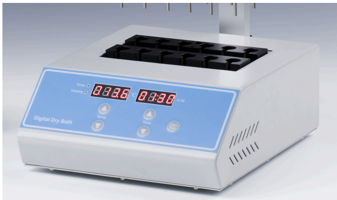
SACO400 - blok sa prorezima u uređaju, prikazi temperature i vremena
