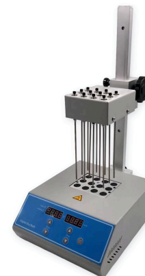
SACO200-1 • un bloc, 12 ace, fiecare cu propria supapă
