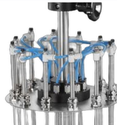
Nadelring • jede Nadel mit eigenem Ventil und eigener Höhe
