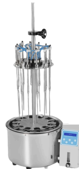
SACO1000 • Wasserbad, 12 Nadeln und Regler mit Durchflussmesser
