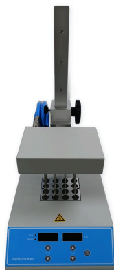
SACO100-2 - vedere laterală, stativ cu reglare pe înălțime cu cremalieră
