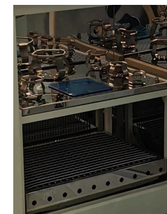
Komora • platforma sa držačima za tikvice i žičana platforma
