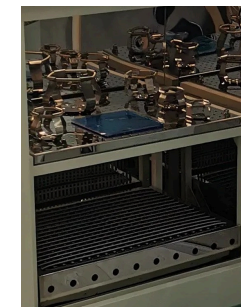
Kammer • Tablar mit Kolbenklammern und Drahttablar
