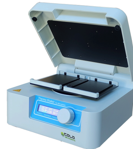
MTP200 • Thermoschüttler für Mikrotiterplatten • zwei Plattenpositionen • Art.-Nr. PRO4503
