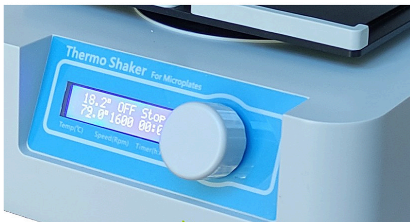
MTP200 • Bedienfeld • LCD-Anzeige und Dreh-Druck-Knopf
