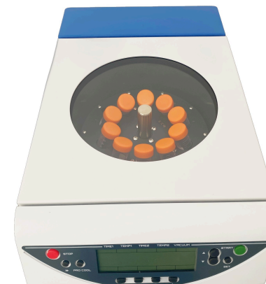
Komora sa rotorom, pogled kroz stakleni prozor
