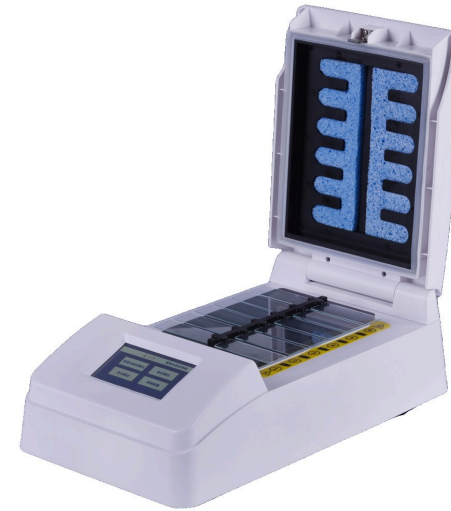
ALHYB • Deckel offen, Objektträger auf der beheizten Plattform, Feuchteschwämme im Deckel
