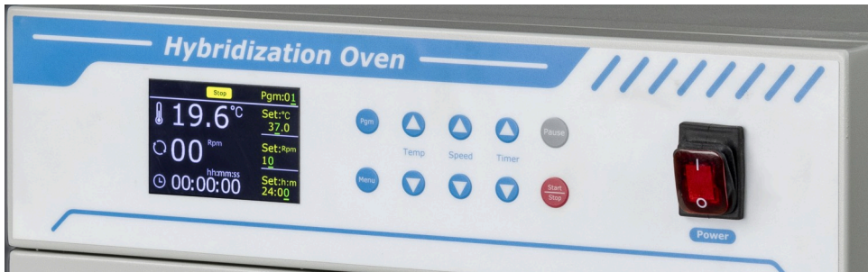
ALHYB-OV • Bedienfeld mit Farbdisplay
