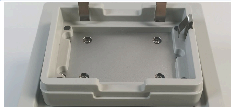
Ležišče bloka • blok se enostavno zamenja in se naroči posebej
