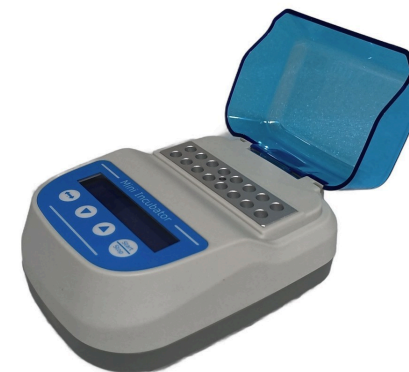
Deckel offen • eingebauter Block 16 × 0,2 ml (PRO4534)
