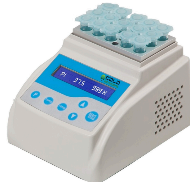
ALEMADR-MB • mini suvi inkubator • prikazan sa opcionim blokom i epruvetama • SKU PRO4345
