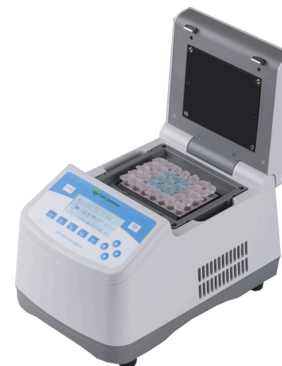
ALEMADR-DBC • beheizter Deckel offen, Block für 35 Röhrchen 1,5 ml
