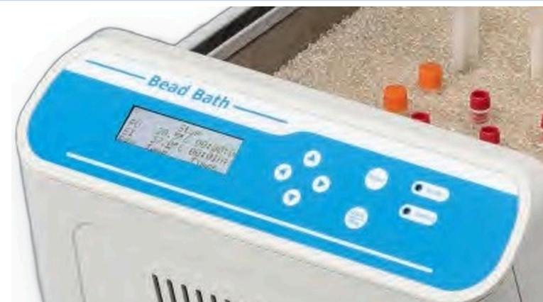
ALEMADR-BB • LCD, tipke za navigacijo, zagon in ustavitev
