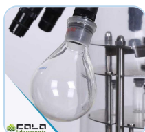
Manifold-Anschluss mit montiertem Kolben
