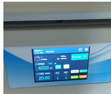
Ekran na dodir za očitavanje i podešavanje parametara i programa
