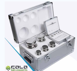
Opcioni set kalibracionih tegova klase F1 (OIML), prema kapacitetu vage
