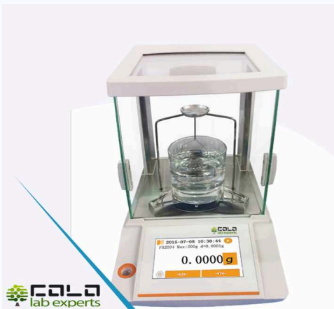
Osnovna jedinica HYBANB sa konfiguracijom za hidrostatsko određivanje gustine
