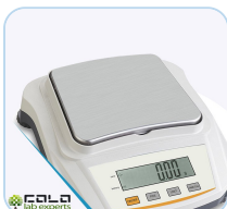
Balanța CENSA așa cum este livrată platan montat, pregătită pentru calibrare
